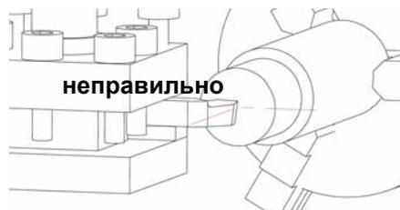
Рис.3-4: Установка токарного резца
